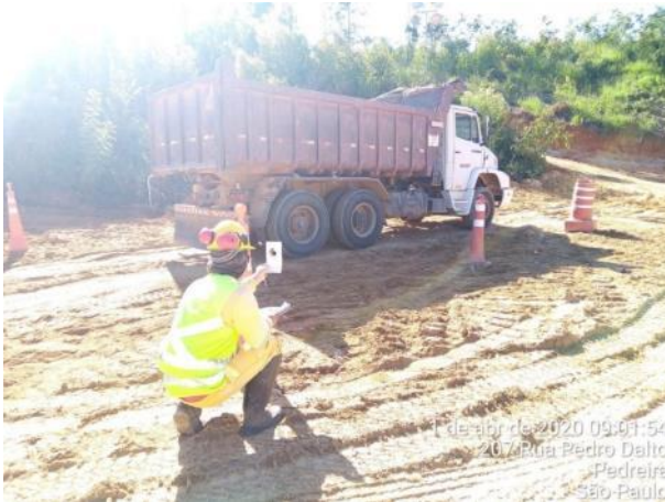
Foto 366 – Inspeção de fumaça preta em caminhão basculante. (Data:01/04/20)
