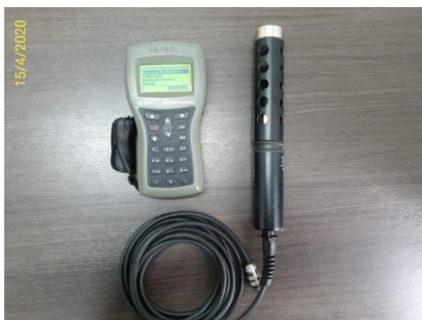
Foto 462 – Sonda multiparâmetros de monitoramento dos parâmetros da água do Rio Jaguari. (Data:15/04/20)
