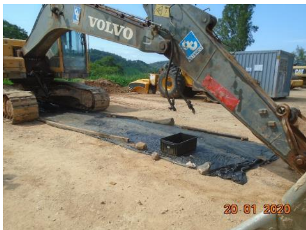
Foto 80 – Manutenção em equipamento com contenção no pátio de mecânica. (Data:20/01/20)
